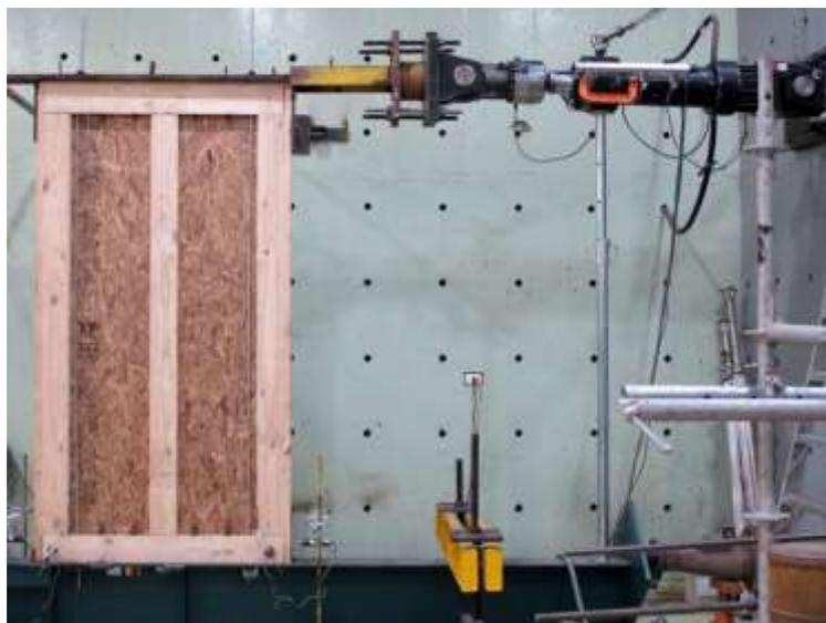
*Figura 3: Configuración de ensayo de carga lateral cíclica.*
