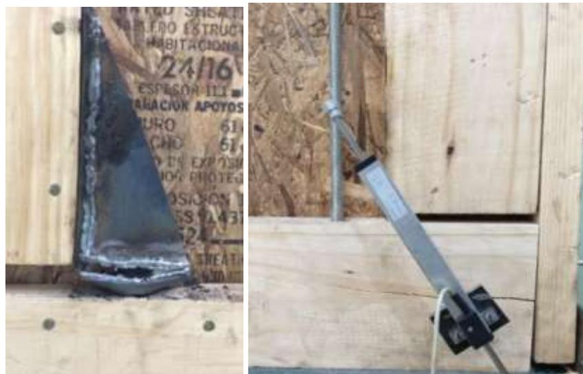
Figura 5: Fallas en los elementos de borde en anclaje “Hold Down” (izq) y barra de acero (der).
