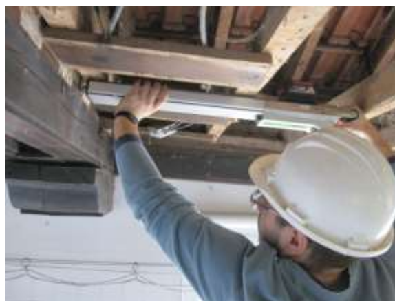
Figura 13: Perfuração com Resistógrafo
