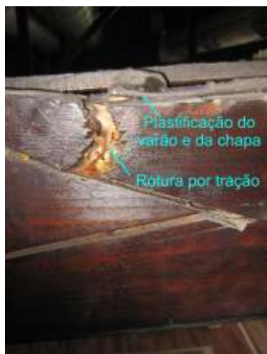
Figura 6: a) Vista geral b) Rotura por corte c) Abertura da junta d) Plastificação do ligador
