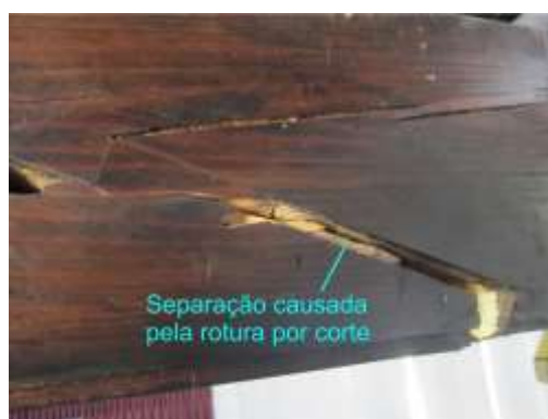
Figura 6: a) Vista geral b) Rotura por corte c) Abertura da junta d) Plastificação do ligador
