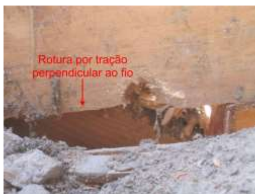
Figura 5: a) Rotura da peça central b) Rotura da ligação
