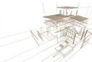
2017), con el fin obtener de manera visual la geometría del edificio y general el preproceso para convertir el modelo a lenguaje OpenSees. La Figura 3 muestra el modelo geométrico de cinco pisos.
