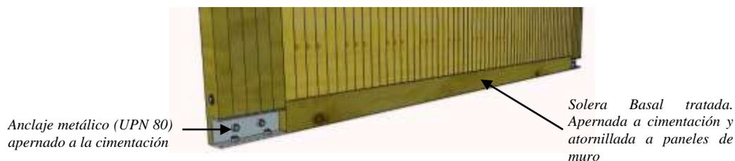
Figura 5: Anclaje de muro a Cimentación corrida
