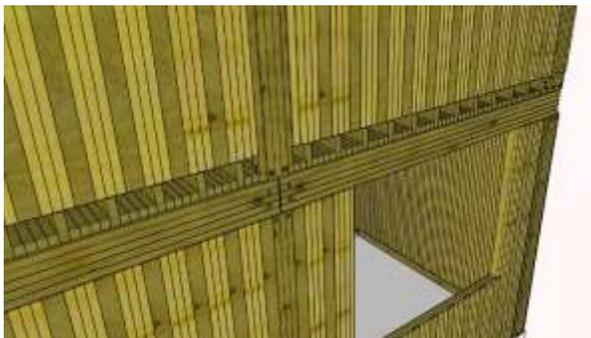
Figura 9: Detalle de losa y muros de segundo piso sin revestir
