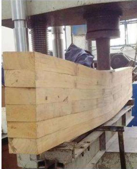
Figura 19. Elemento viga de 30 cm de altura al inicio y final del ensayo.
