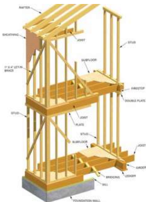
Figura 1. Sistema constructivo Platform-frame
