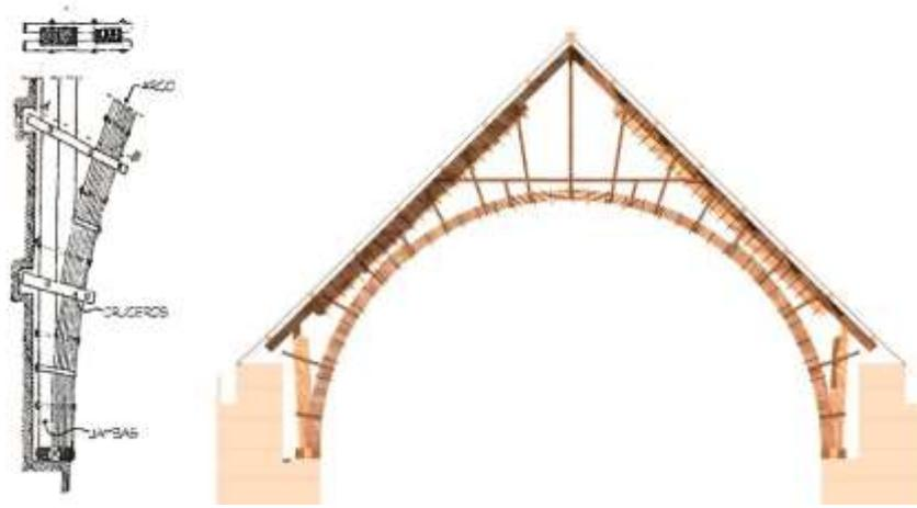
Fig.4 Jabalcón (jambas), y estructura actual[Torres, 1999 – dibujo propio]
