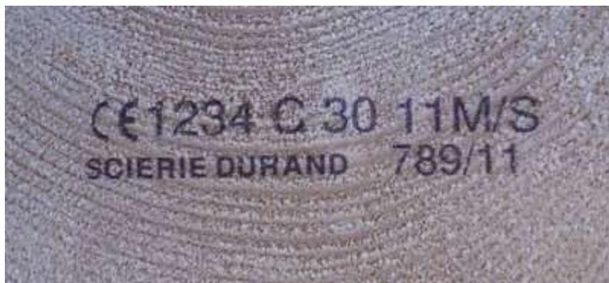
Figura 2. Ejemplo de marcado de una clase resistente “C30” de la empresa INNODURA, Francia ([www.innodura.fr](http://www.innodura.fr))
