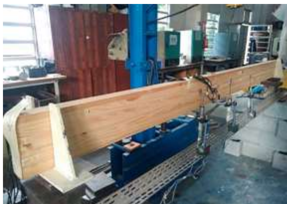
Figura 2: Viga preparada para o ensaio.
