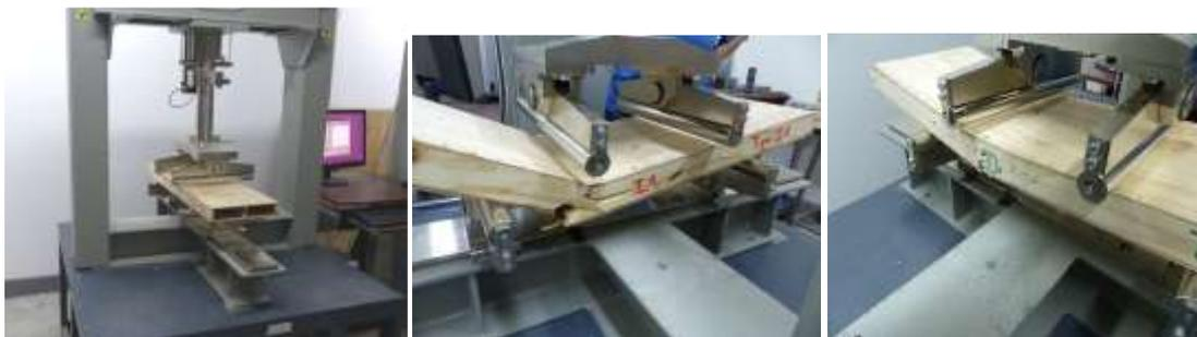
*Figura 2 Prensa universal Controls y formas de rotura de las losetas.*
