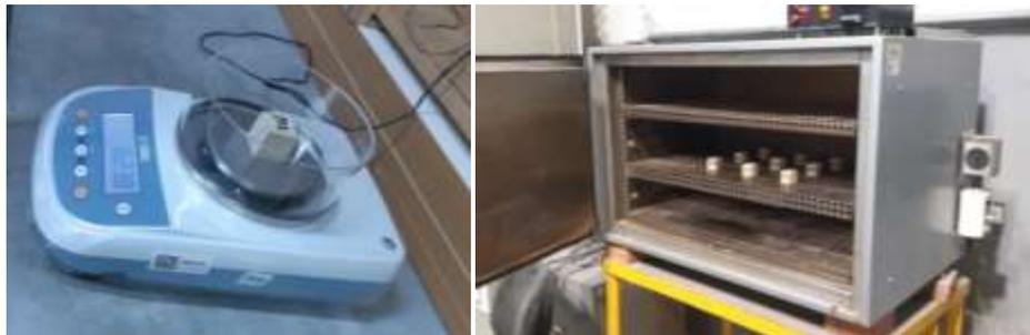
Figura 5. Balanza de precisión y probetas en el horno de secado
